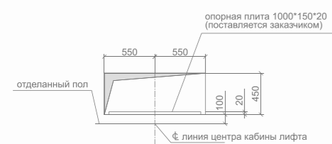
А-А грузоподъемность проёма
